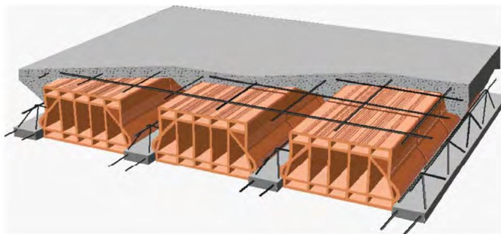
**Figura 23.2 - Esempio di solaio in cemento armato a travetti tralicciati e blocchi interposti<sup>4</sup>**
