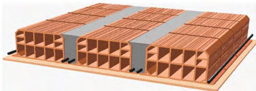
**Figura 23.1 - Esempio di solaio in cemento armato gettato in opera<sup>3</sup>**
