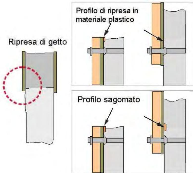
Figura 67.8 - Giunti delle casseforme in evidenza
