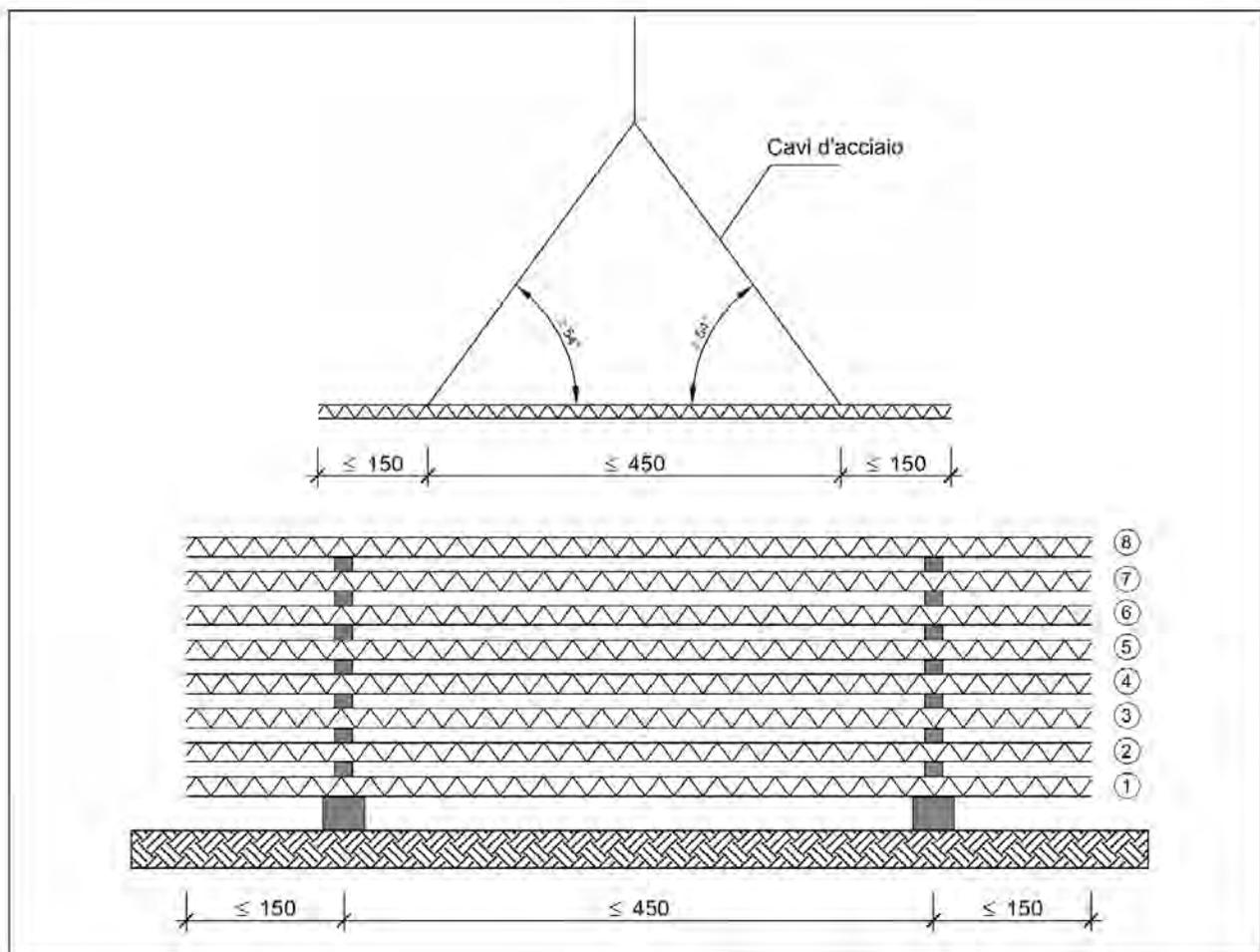
**Figura 23.6 - Esempio di stoccaggio di travetti tralicciati**
