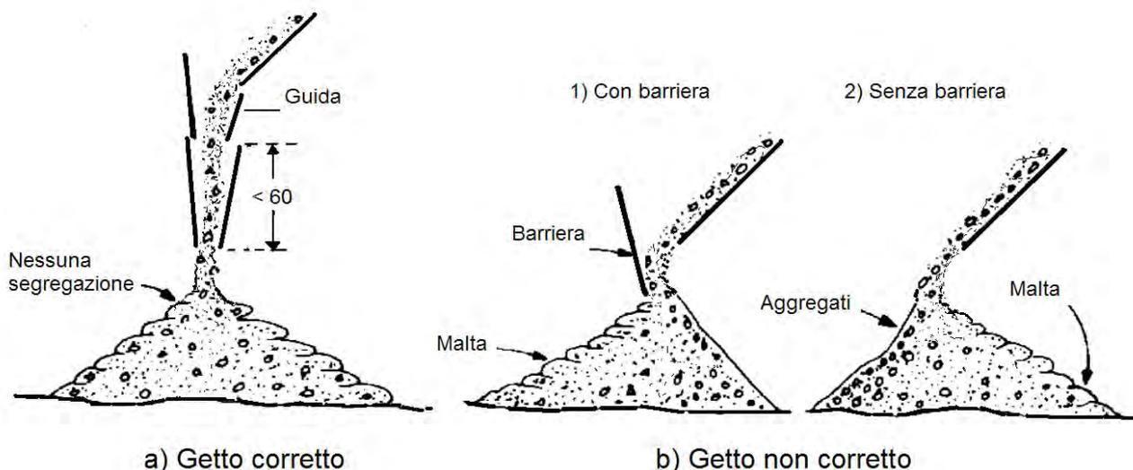
**Figura 67.2 - Esempi di getto di calcestruzzo da piano inclinato: a) getto corretto e b) getto non corretto. Nel caso b) si ha la separazione degli aggregati dalla malta cementizia. La barriera comporta soltanto il cambiamento di direzione della segregazione.**
