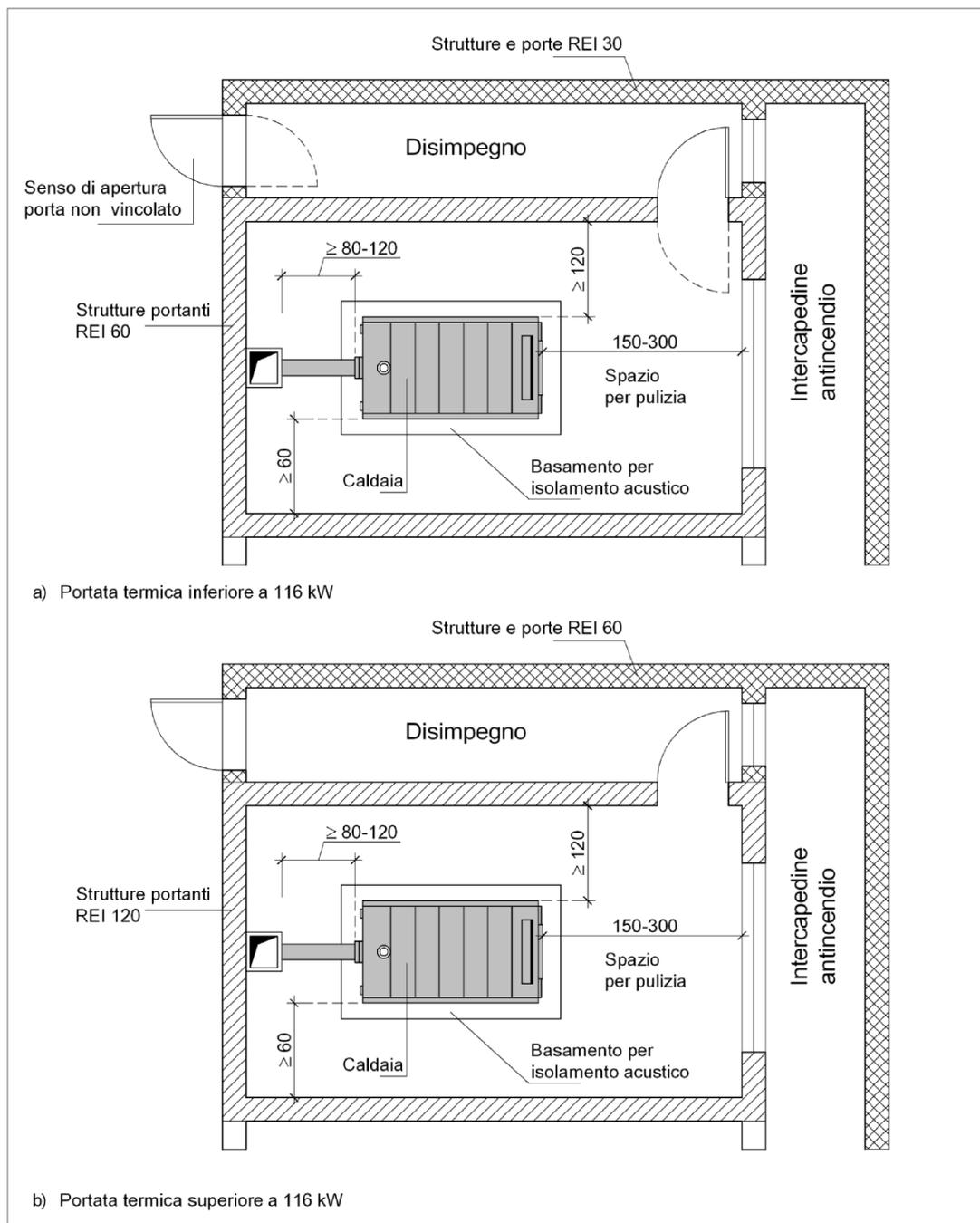
**Figura 90.9 - Esempio di centrale termica alimentata a gas di rete con accesso da disimpegno con parete attestata su intercapedine antincendio. Caratteristiche costruttive e distanze minime consigliate per gli spazi attorno al generatore**
