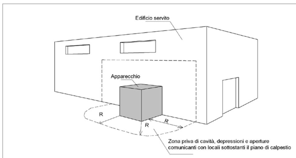
**Figura 90.3 - Distanze da rispettare per l'installazione all'aperto degli apparecchi alimentati con gas a densità maggiore di 0,8**
