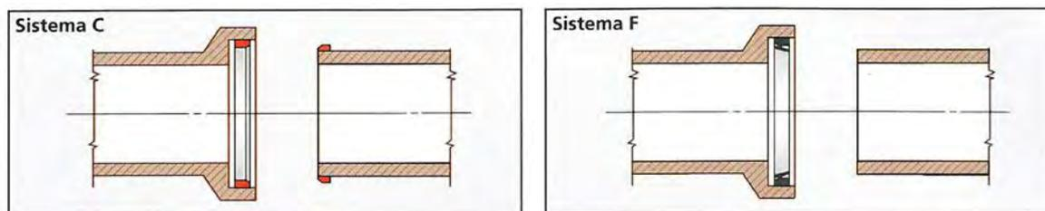
**Figura 45. 1 - Sistemi di giunzioni tubi in gres con giunto a bicchiere e guarnizione elastica (norma UNI EN 295)**
