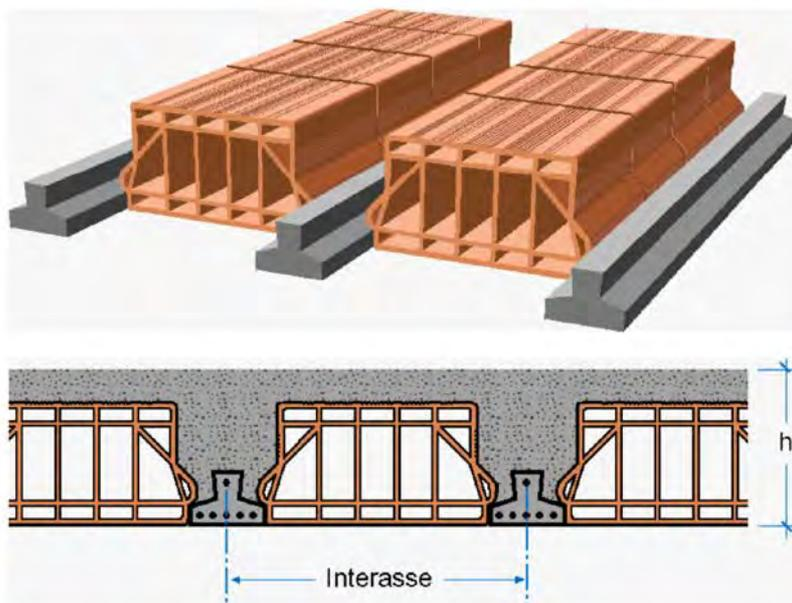
**Figura 23.3 - Esempio di solaio in cemento armato a travetti in cemento armato e blocchi interposti<sup>5</sup>**
