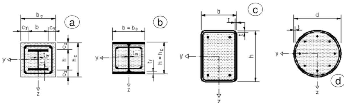
**Figura 75.1 - Tipi di sezioni per colonne composte**
