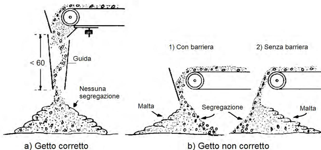
**Figura 67.1 - Esempi di getto di calcestruzzo con nastro trasportatore: a) getto corretto e b) getto non corretto. Nel caso b) si ha la separazione degli aggregati dalla malta cementizia. La barriera comporta soltanto il cambiamento di direzione della segregazione.**
